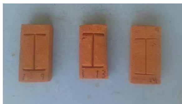
Figura 5. Briquetas horneadas a 850 C
