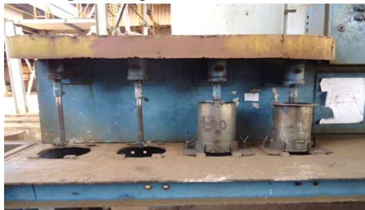
Figura 2. Banco de reactores utilizados para lixiviar.
