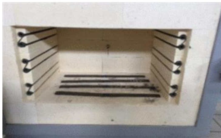
Figura 1. Calentamiento de probetas en muflas. Fuente: Autor
