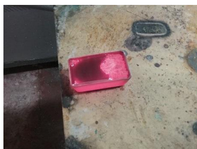
Figura 4. muestra #1 después de vaciada en la lingotera.
