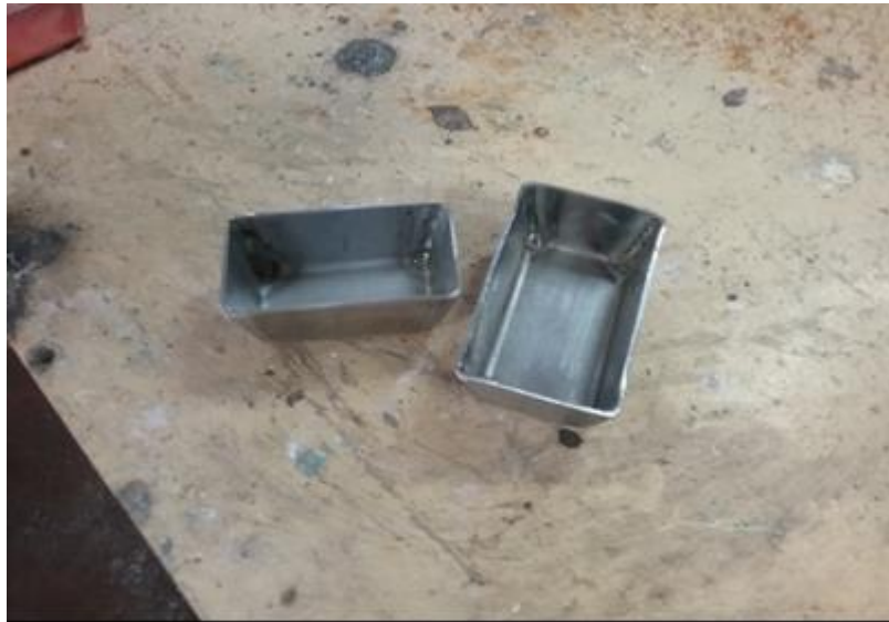
Figura 3. Las capsulas confeccionadas de aceros inoxidables.
