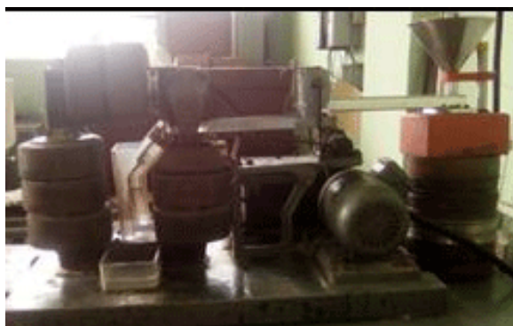
Figura 1. Separador magnético SM-138T de alta intensidad vía seca.
