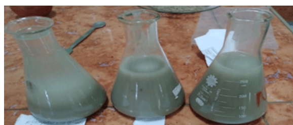
Figura 3. Fases formadas una vez concluida la prueba, de izquierda a derecha (pH neutro, ácido y básico) bajo 200 mallas.
