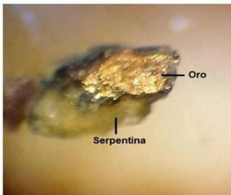
Imagen 6 y 7. Derecha, grano de oro en serpentinafracc. +0.212m, izquierda grano de oro librefracc. +0.106 mm
