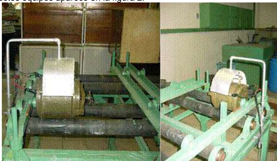
Figura 2. Sistema de laboratorio para preparación de pulpas de alto % de sólidos.
