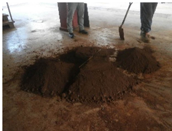
Figura 1. Cuarteo y homogeneización de la muestra.
