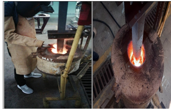
Figura 2. Horno de arco eléctrico empleado en las pruebas experimentales de fusión-reducción.
