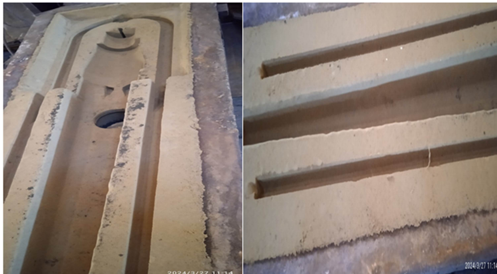
Figura 5. Aplicación de pinturas en brazos de hornos de reducción de acero, a base de rechazo serpentinitico.
