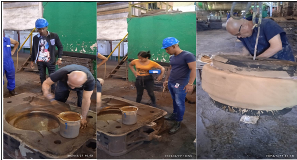
Figura 4. Aplicación de las pinturas preparadas a base de rechazo serpentinitico, en bomba de hierro fundido
