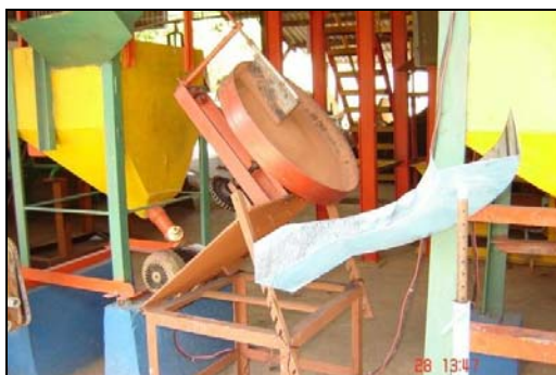
Figura 1. Disco aglomerador empleado en las pruebas.
