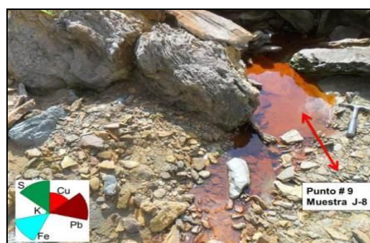
Fig. 3. Muestra de agua tomada en la presa de colas con presencia de Cu, Pb, Fe, S.
