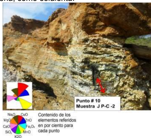
Fig.4. Muestra de sedimentos tomada en la presa de colas. El diagrama de rosa, destaca los óxidos Mn (amarillo), Cu (rojo), Zn (azul).
